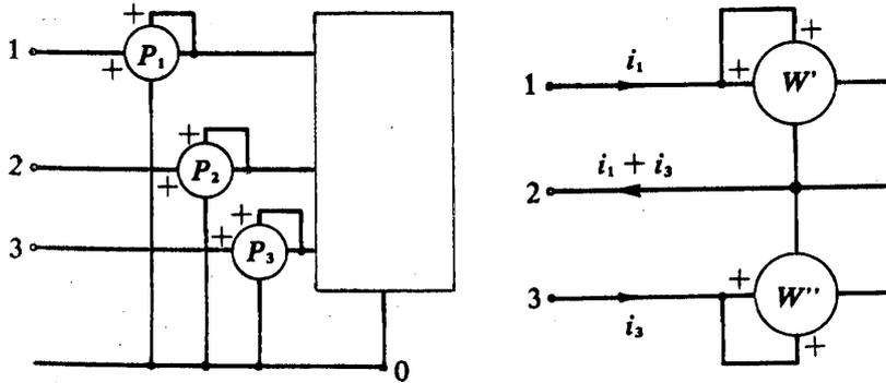
Figura 5: Misura della potenza in una rete trifase
