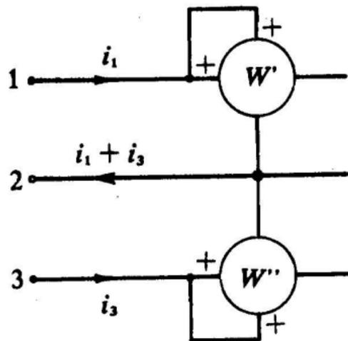
Figure: Misura della potenza in una rete trifase
