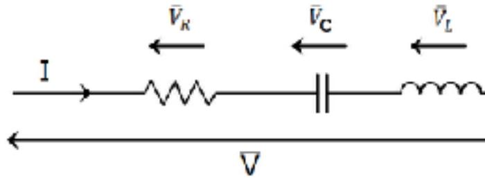
Se avessimo un lato composto da una serie di resistore, condensatore e induttore, esso, a seconda di quale dei due componenti con memoria prevale, può essere ricondotto a uno dei due lati esaminati in precedenza: avremo un lato ohmico-induttivo se a prevalere è l'induttore (impedenza  $X$  totale maggiore di zero) oppure un lato ohmico-capacitivo se a prevalere è invece il condensatore (impedenza  $X$  totale minore di zero).
