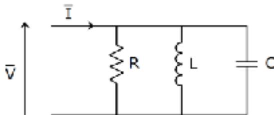
Applicando il concetto di dualità è possibile verificare velocemente cosa accade se il circuito RLC è in parallelo: al posto del modulo dell'impedenza  $|Z|$  avremo il modulo dell'ammettenza  $|Y|$  e quindi la retta che aveva come equazione  $\omega L$  ora è  $\omega C$ , mentre l'iperbole diventa  $\frac{1}{\omega L}$  e la  $R$  diventa  $G$ .
