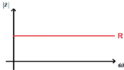
La parte reale dell'impedenza è costante e non varia al variare della pulsazione solo se sto analizzando un singolo resistore; se infatti avessimo un resistore accoppiato con un induttore o con un condensatore allora l'impedenza equivalente dipenderà dalla pulsazione:
