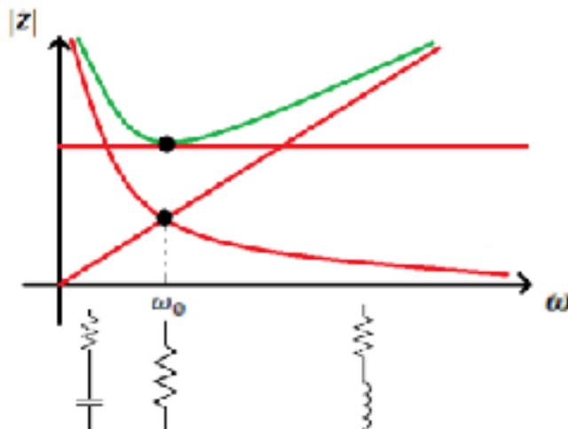
Dove la curva in **verde** rappresenta l'andamento dell'impedenza in funzione della pulsazione. Si nota che quando la curva del condensatore si interseca con la retta dell'induttore abbiamo il caso della risonanza (con  $\omega_0$  che è la *pulsazione di risonanza*): la curva dell'impedenza ha un minimo in corrispondenza di tale valore e il circuito assumerà un comportamento *puramente resistivo*.
