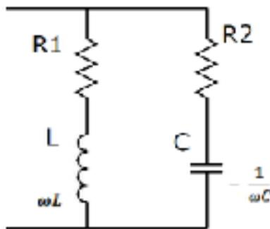
Se abbiamo pulsazioni molto basse, tendenti allo zero, avremo che l'impedenza equivalente è  $R1$  e come rappresentazione esterna avremo un *cortocircuito* ideale per il primo lato e un *circuito aperto* per il secondo; se, invece, abbiamo pulsazioni molto alte, tendenti all'infinito, l'impedenza equivalente sarà  $R2$  con un circuito aperto per il primo lato e un cortocircuito per il secondo:
