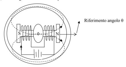
Tra la parte mobile (rotore) e quella fissa (statore) c'è uno spazio in aria (permeabilità relativa unitaria) che è detto **traferro**. La riluttanza dell'aria risulta, in generale, essere molto più grande di quella del ferro in virtù dell'alta permeabiltà di quest'ultimo che è >>1. Quindi si ha:
