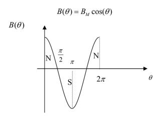
Alimentiamo ora i conduttori di statore con un generatore di corrente che varia nel tempo in modo puramente sinusoidale con pulsazione ω:
