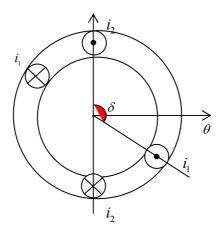
Si dispongono sullo statore due avvolgimenti, meccanicamente "sfasati" di un angolo  $\delta$ , come in figura, e percorsi da correnti di uguale ampiezza ma sfasate nel tempo di una quantità  $\alpha$ :
