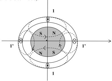
Ricapitolando per p coppie polari: nel caso di campo magnetico generato dallo statore la velocità del campo, indicata con n, è direttamente legata alla frequenza dalle relazioni:  $f = 50Hz \rightarrow n = \frac{60 f}{p}$ , così ad esempio il numero giri al minuto del campo magnetico rotante per 2 coppie polari è 1500 giri/minuto.
